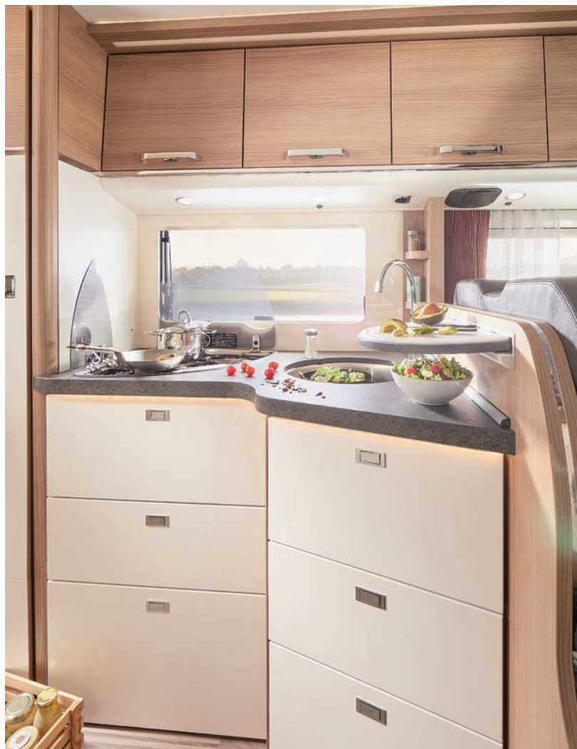
▲ Vinkelkjøkken med seks store skuffer, gasskokeapparat med 3 bluss, støpejernsrist og rund innfelt oppvaskkum (modeller I/T 410 DB, 440 LE, 440 QB, 460 LE).
