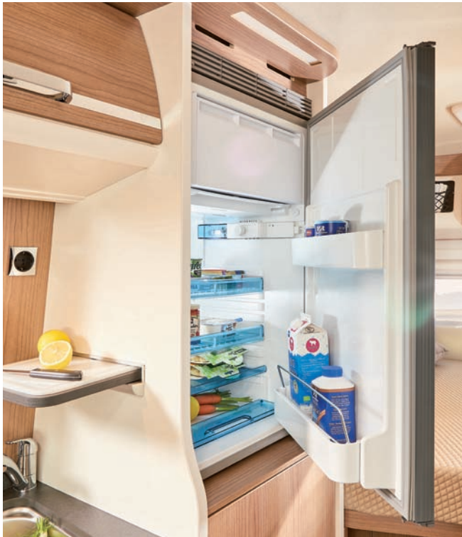
▲ Absorpsjonskjøleskapet, som er eksklusivt utviklet for Malibu, kan drives med gass, 12 V eller 230 V.
